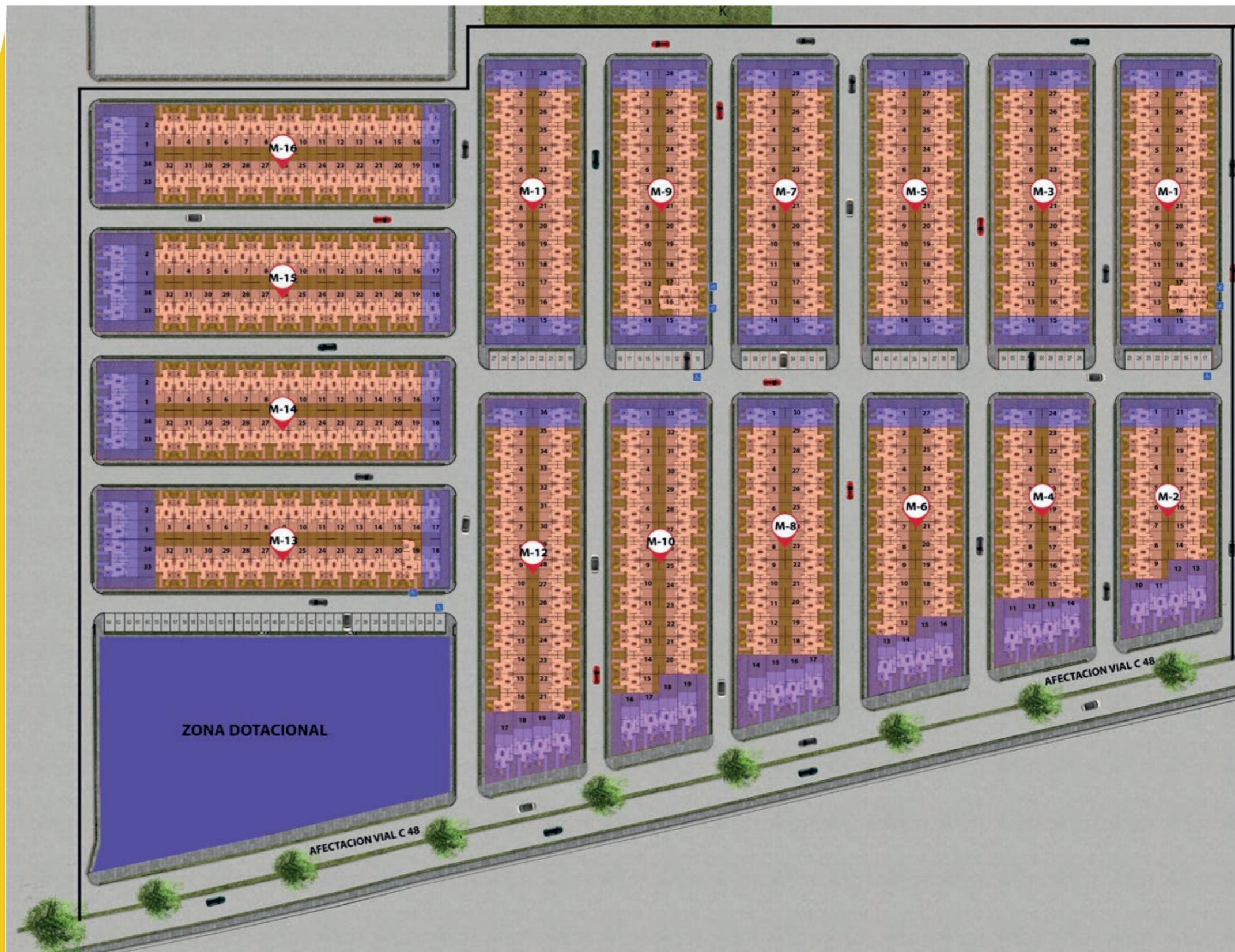
El diseño plantea una casa de dos (2) niveles en obra gris con un área construida de 46.99 m<sup>2</sup>, en lotes con área de 62.50 m<sup>2</sup>, con frente mínimo de 5 metros. Los muros de la vivienda serán construidos en bloque estructural hasta una altura de 2.40 mts.
